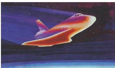
Figuur 13 De invloed van luchtweerstand is goed merkbaar als een ruimtecapsule terugkeert in de dampkring van de aarde. Er is dan zelfs een hittedeksel nodig om te voorkomen dat de capsule smelt.
