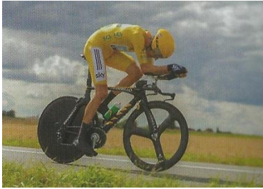
Figuur 25 Bij een mechanisch vermogen van 400 W bereikt een wielrenner een snelheid van zo'n 50 km/h.
