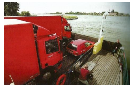
Figuur 13 Een betere stroomlijn door een spoiler op de cabine van een vrachtauto zorgt voor een lager brandstofverbruik.
