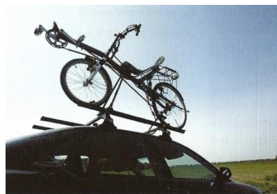
Figuur 12 Een slechtere stroomlijn door een imperiaal op het dak van een auto zorgt voor een hoger brandstofverbruik.
