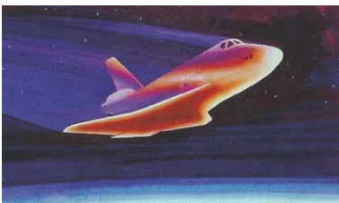
Figuur 11 De invloed van luchtweerstand is goed merkbaar als een ruimtecapsule terugkeert in de dampkring van de aarde. Er is dan zelfs een hiteschild nodig om te voorkomen dat de capsule smelt.
