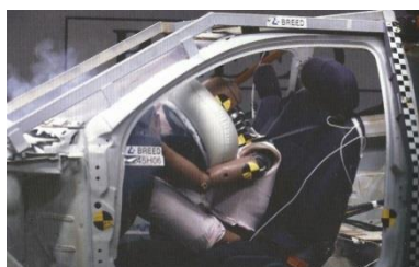
Figuur 27 De autogordel en airbag remmen het lichaam geleidelijk af bij een botsing.
