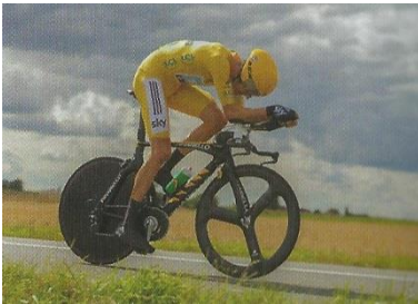
Figuur 19 Bij een mechanisch vermogen van 400 W bereikt een wielrenner een snelheid van zo'n 50 km/h.
