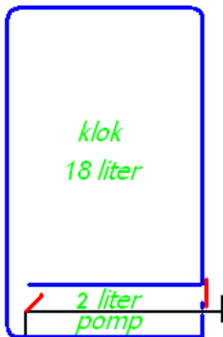
Fig. 4.2: schematische pomp met vereenvoudigde maten.
