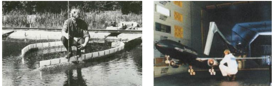
Figuur 1 – Een schaalmodel van een havenmonding (links) en van een vliegtuig in een windtunnel (rechts). Deze modellen zijn een hulpmiddel bij onderzoek. In deze modellen wordt de werkelijkheid weergegeven voor zover die voor het onderzoek van belang is.
